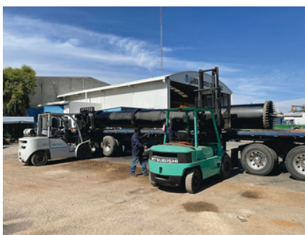
🔧 Bombas tipo flujo mixto # Modelo 30 LS 📏 2,000 l.p.s (31,700 g.p.m)
